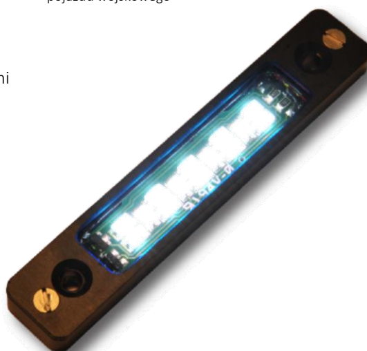
System białych światel rozproszonych mini zamontowanych w kabinie pojazdu wojskowego
